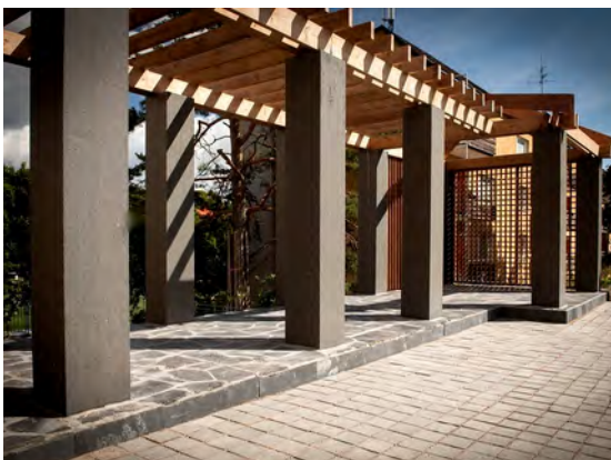
Kivipergolan kivilattiassa musta liuskekivi, pilarit Varpaisjärven mustaa graniittia
